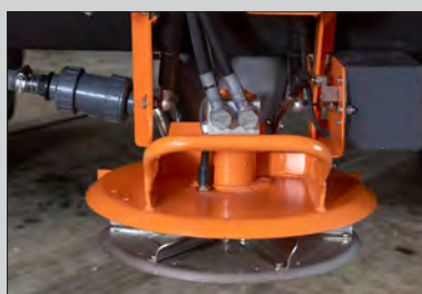
Комбінований дисковий і роторний розкидач з шириною розкидання 1,5–6,0 м з використанням розкидаючого диска. За допомогою ротора досягається розкидання з 1,2 м (TP3) та 1,8 м (TP9).
